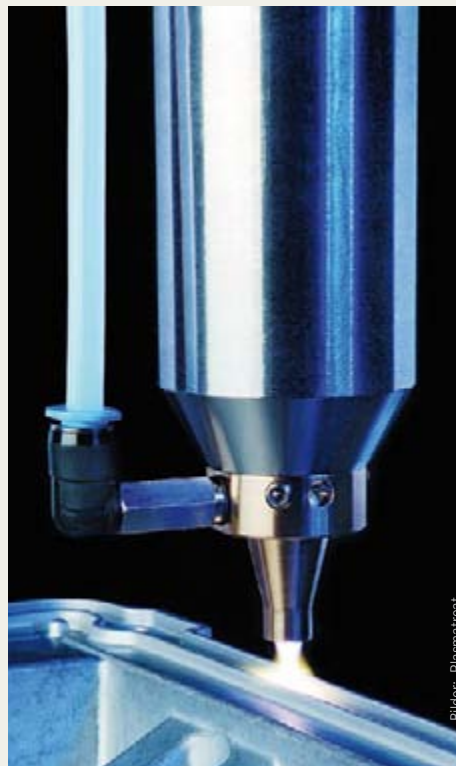
Die Atmosphärendruck-Plasmabeschichtung lässt sich ideal in die bestehende Fertigung von Aluminiumbauteilen einfügen
