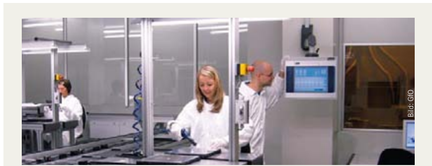
▲ In Reinraum 1 erfolgt die manuelle Auf- und Abgabe der Werkstücke. In Reinraum 2 (rechts hinten) werden die Displays vor dem Lackieren mit Plasma unter Normaldruck inline vorbehandelt.
