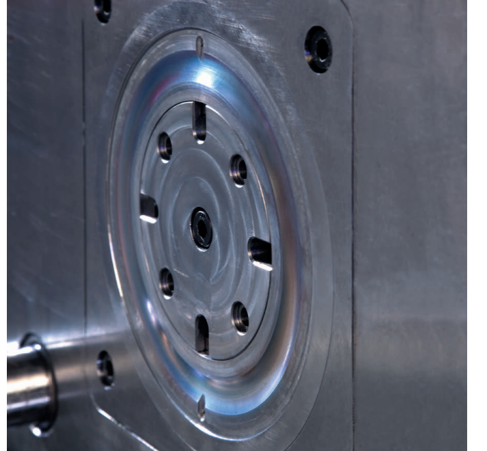
Kalıp içine açık mavi PlasmaPlus® polimerizasyonu
