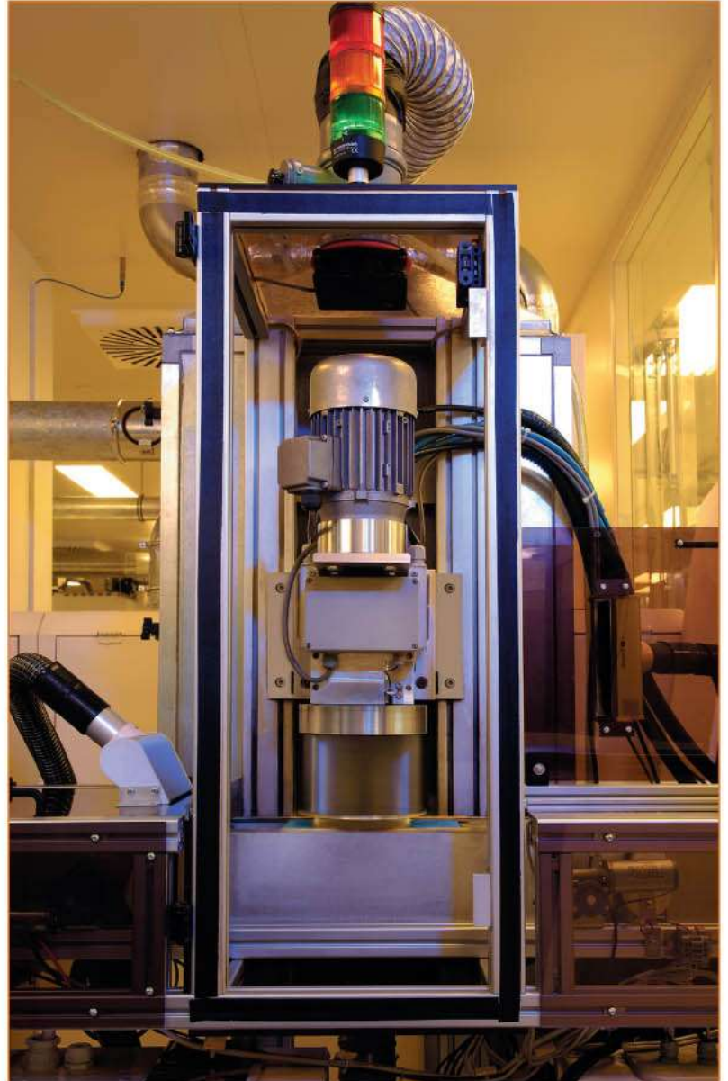
Şekil.4. Devre kartları plazma sisteminden geçerek serigrafi baskı sistemine kesintisiz şekilde gider. Novotechnik'e yerden tasarruf sağlayan plazma sistemi dört serigrafi baskı hattına ürün sağlamaktadır.
