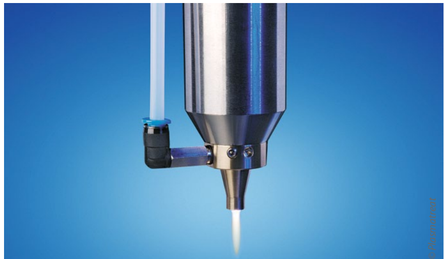
Bild 1: Im Zentrum des atmosphärischen Plasmaverfahrens steht eine Plasmadüse, in der sich ein komplexes Beschichtungssystem verbirgt. Funktionale Nanoschichten können damit ortselektiv aufgebracht werden.
