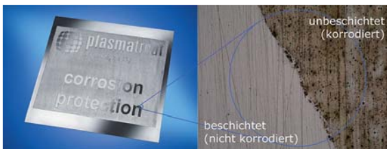
Abb. 5: Der mit der PlasmaPlus-Schicht geschützte Bereich zeigt auch nach Einwirkung von 96 Stunden Salzsprühnebel Korrosionszeichen.
