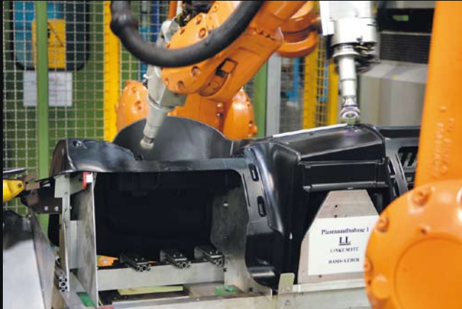
Die an zwei Roboterarmen montierten Plasmadüsen fahren konturgenau die Oberfläche ab und sparen dabei exakt die Bereiche aus, an denen keine PUR-Schaumhaftung erfolgen soll.
