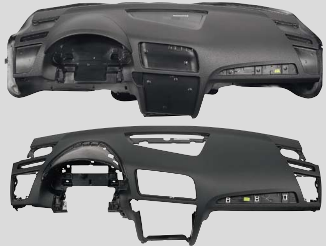
Instrumententräger nach Plasmabehandlung, Slushhaut- und Schaumverklebung sowie rückseitiger Hautschwächung im Bereich des Airbags (oben). Eine Fräsanlage sorgt für die Instrumentenöffnungen. Von den nicht plasmabehandelten Bereichen kann die hintergeschäumte Slushhaut leicht manuell entfernt werden.
