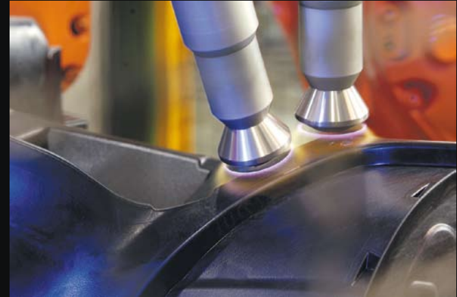
Die Düsen arbeiten ortsselektiv. Das kalte Plasma bewirkt eine Reinigung und Aktivierung der langglasfaserverstärkten PP-Oberfläche der Instrumententafel selbst bei komplexen Bauteilgeometrien.
