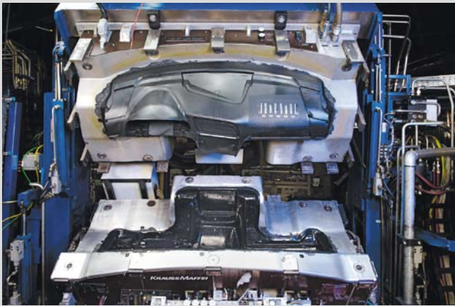
Wie ein gigantischer Sandwichtoaster erscheint die Schaumanlage im geöffneten Zustand. Auf die unten eingelegte schwarze Slushhaut wird der PUR-Schaum aufgetragen, der sich nach dem Zusammenklappen zwischen PP-Träger (oben) und Haut vollflächig verteilt und beide Teile miteinander verklebt.
