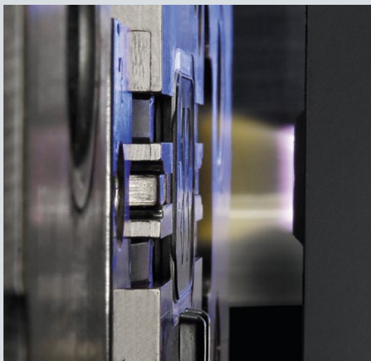
Bild 1: Mit nahezu Schallgeschwindigkeit trifft das Openair-Plasma auf die Polycarbonat-Linsen. Die mikrofeine Reinigung und hohe Aktivierung verleiht dem Kunststoff neue Haftungseigenschaften.
