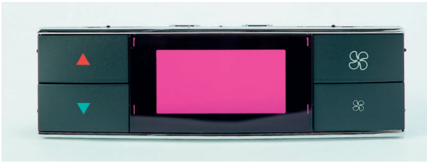
Bild 3. Eingefärbtes Displayfenster für die Klimaanlage. Die Vorbehandlung mit Atmosphärendruckplasma sorgt für die makellose Optik und optimale Haftung der Kratzfestbeschichtung (Foto: GfO)
