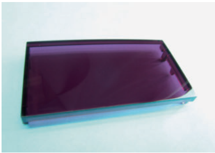
Bild 6. Die mikrofein gereinigten und hoch aktivierten Kunststoffe erhalten in direktem Anschluss an die Bestrahlung mit Plasma in der Lackierstation ihre Kratzfestbeschichtung
